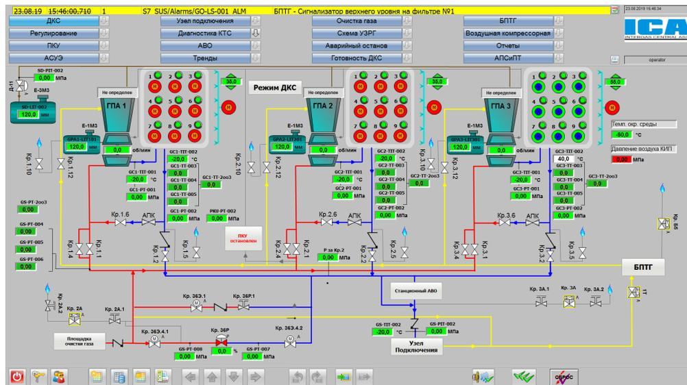
АСУ ТП ДКС предназначена для автоматизации технологических и вспомогательных объектов дожимной компрессорной станции. АСУ ТП ДКС обеспечивает информационное взаимодействие с системой диспетчерского управления АО «ИЦА». Решения, закладываемые при создании АСУ ТП ДКС, обеспечивает возможность обслуживающему персоналу совершенствовать и наращивать функции на дальнейших этапах эксплуатации ДКС
